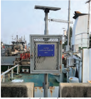
รูปที่ 16 เครื่องวัดระดับน้ำอัตโนมัติ
