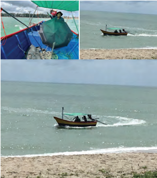
รูปที่ 22 การสำรวจหยั่งน้ำเก็บข้อมูลตามแนวสำรวจ
