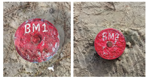
รูปที่ 2 หมุดหลักฐาน BM01,BM02
