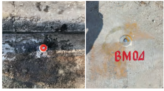
รูปที่ 4 หมุดหลักฐาน BM03,BM04
